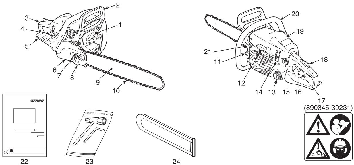
1. **Tlumič** – tlumič snižuje hluk výfuku a brání unikání horkých a žhavých uhlíkových částic z tlumiče.
